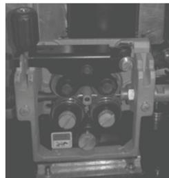
Cada arame exige um tipo específico de ranhura, (v) (u) (estriada), verifique na descrição de seu arame.
